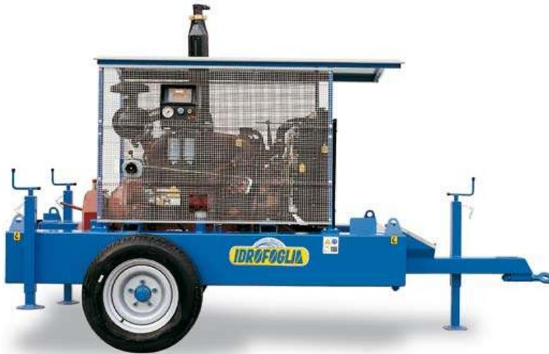
GRUPPI MOTOFRIZIONE con motore IVECO AIFO-JOHN DEERE raffreddato a liquido, frizione industriale flangiata, telaio su 2 ruote gommata con serbatoio incorporato, piedini di stazionamento, avviamento elettrico con batteria, centralina di protezione motore (nel caso di bassa pressione olio, alta temperatura motore, rottura cinghia e caduta pressione idrica) completo di contagiri, contaore, manometro, pressostato, chiave di avviamento e spie luminose.
